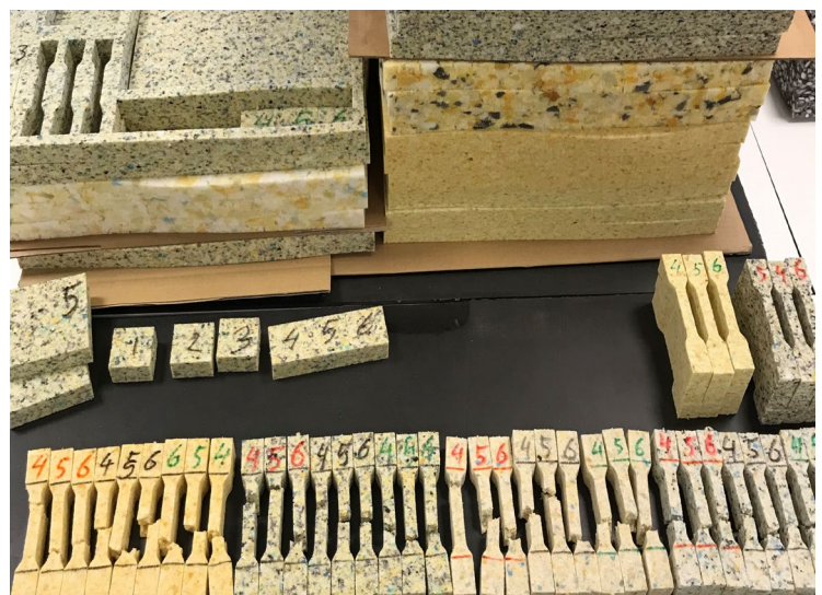
Foto: Skumprøver til mekanisk test hos BPI - kilde: BPI 2022
