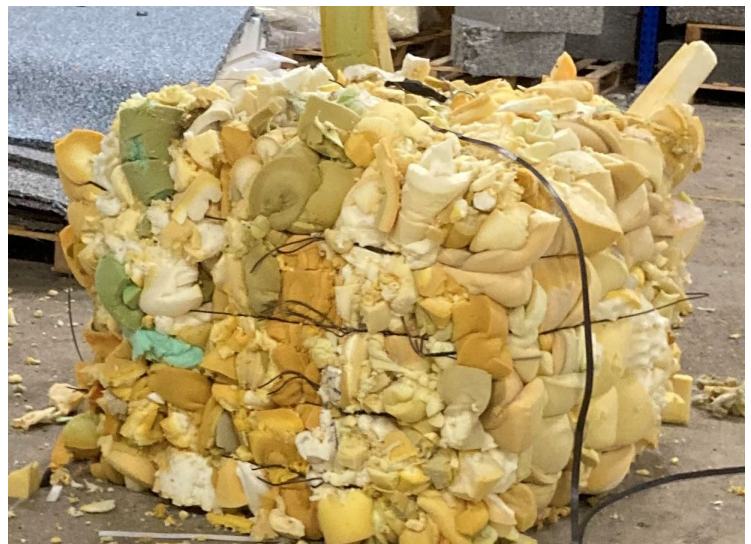
Foto: Balle af PUR-skum fra danske madrasser modtaget hos BPI – kilde: BPI 2022
